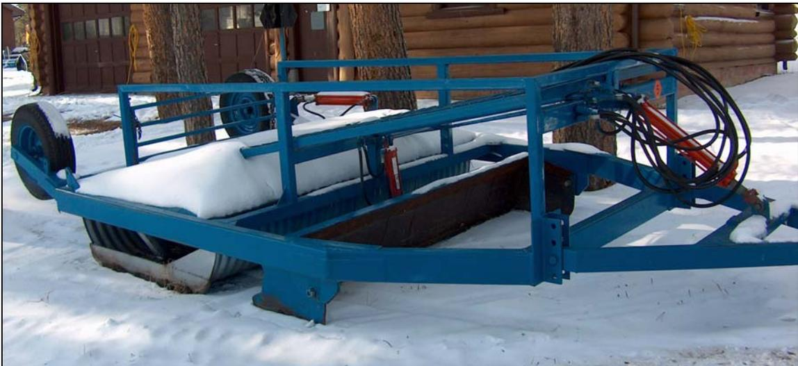
**Photo 2.18** Traîneau niveleur à lame simple de type courant
