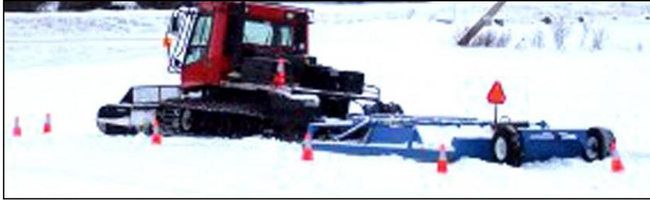
**Photo 3.3** Mettre en place des cônes ou autres dispositifs de mise en garde autour et à l'avant d'une dameuse tombée en panne sur la piste et que l'on doit immobiliser durant une période prolongée.
