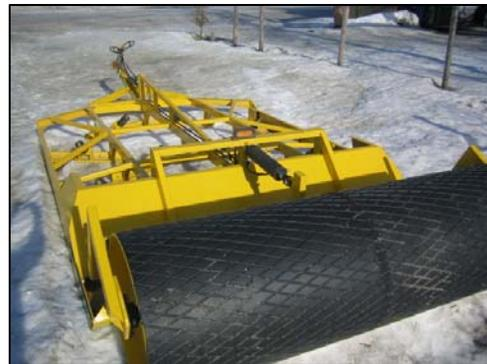
**Photo 2.16** Rouleau à tambour arrière de type courant
