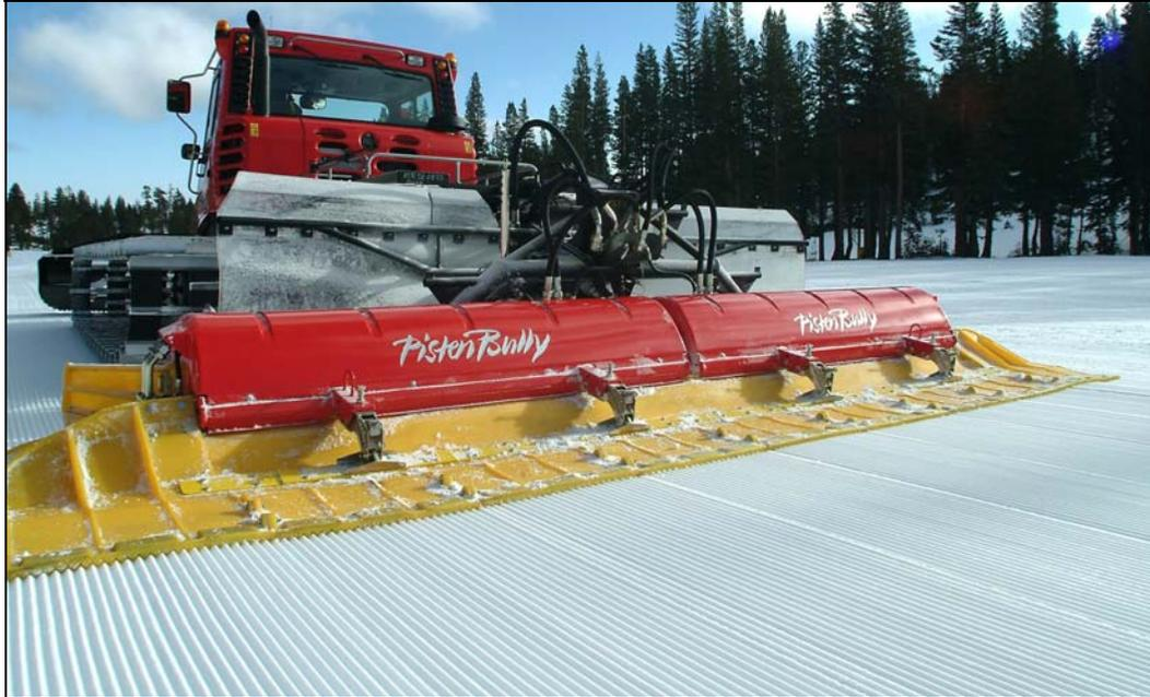
**Photo 2.22** Mélangeur flexible réglé en position rigide (droite) à l'aide du dispositif de verrouillage illustré ci-dessous
