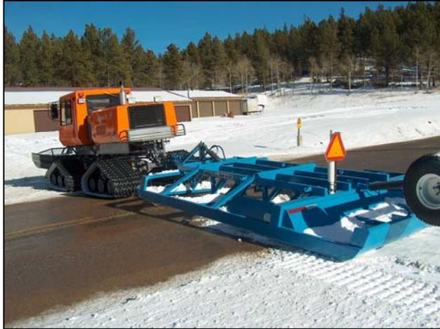
**Photo 4.8** Toujours lever le traîneau niveleur pour traverser une route
