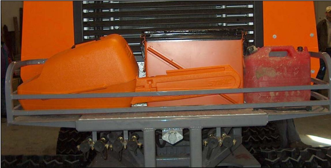
**Photo 2.30** Plateforme arrière de type courant utilisée pour le transport des outils, des panneaux de signalisation de rechange et de la réserve de carburant
