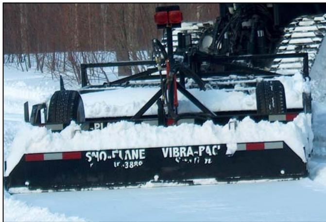
ces derniers étant déjà équipés d'un système hydraulique adapté à la commande d'une plaque vibrante (voir photo 2.14).
