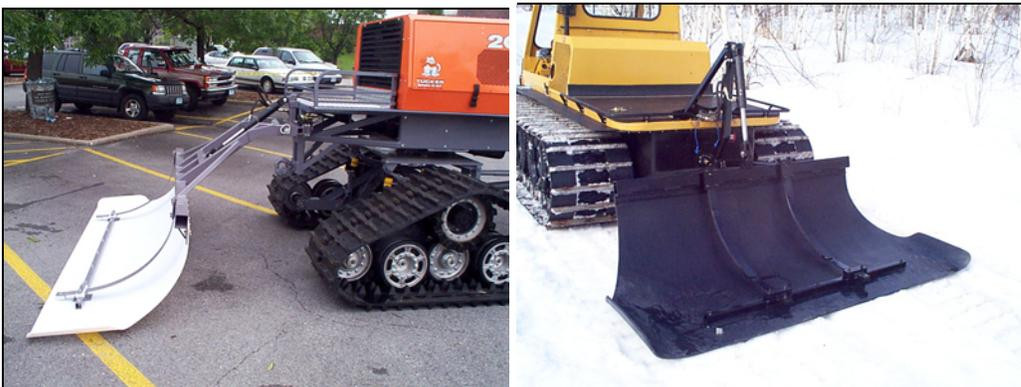
**Photo 2.24** Barres de compactage de type courant
