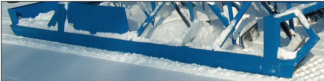
Photo 2.4 Le longeron latéral sur un traîneau niveleur à lames multiples facilite la retenue de la neige dans le traîneau.
