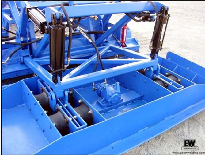
**Photo 2.14** Plaques vibrantes arrière de type courant
