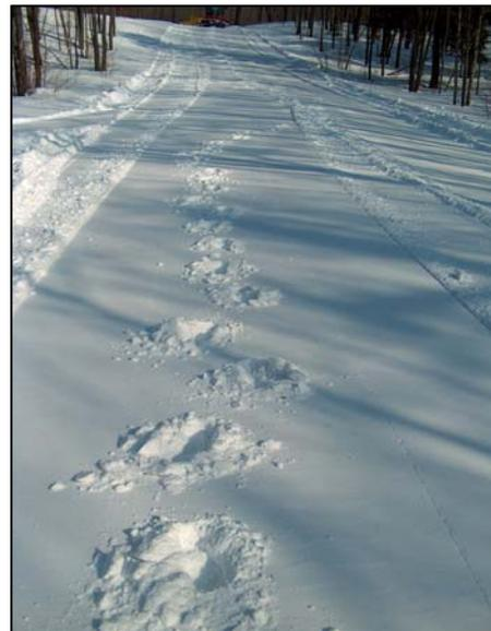
**Photo 1.9** Exemple « d'essai à la botte » révélant une piste molle
