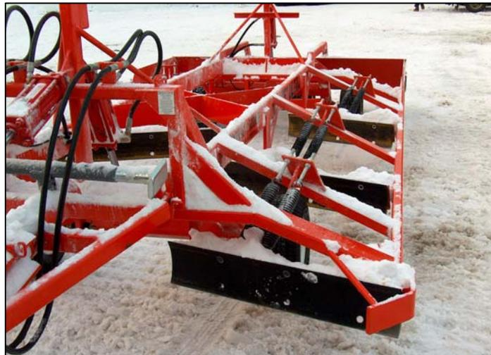
**Photo 2.1** Traîneau niveleur à lames multiples de type courant
