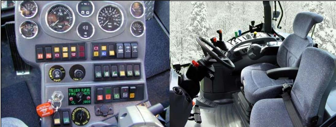
**Photo 2.28** Commandes classiques dans une cabine de tracteur
