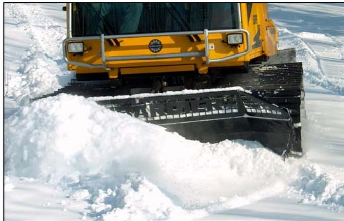
**Photo 2.29** Lame avant classique à l'œuvre
