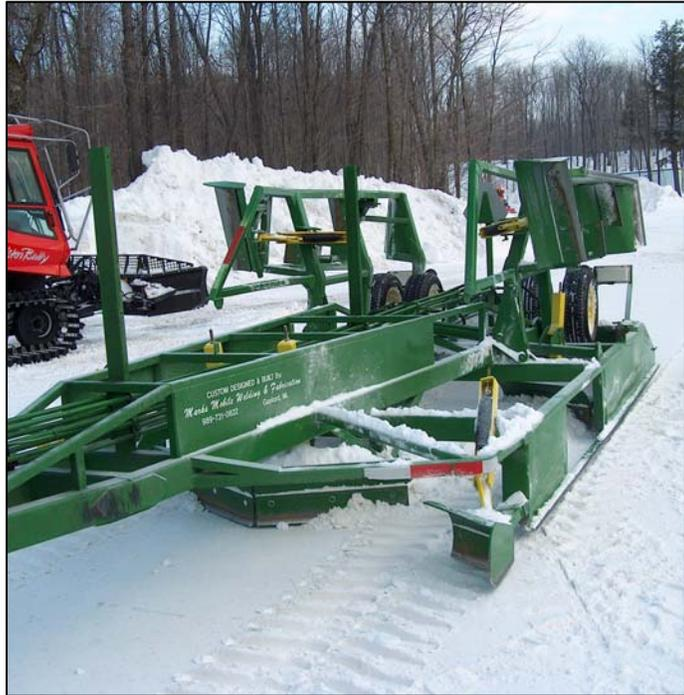
**Photo 2.2** Traîneau niveleur équipé d'ailes hydrauliques
