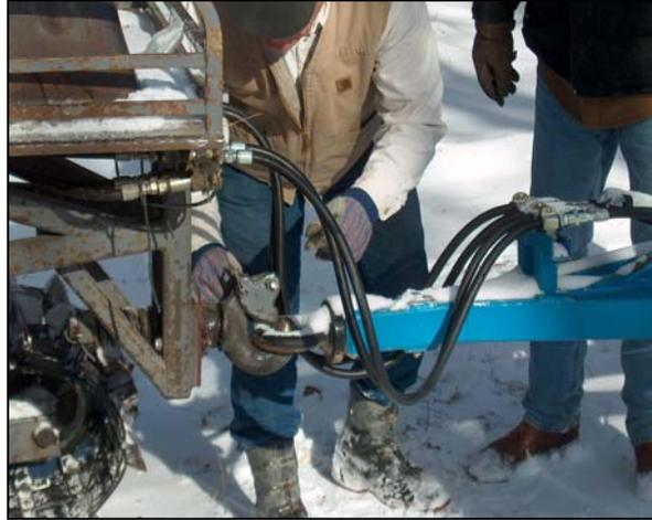
**Photo 2.17** Raccords rapides et goupille de cisaillement dans la flèche du crochet d'attelage
