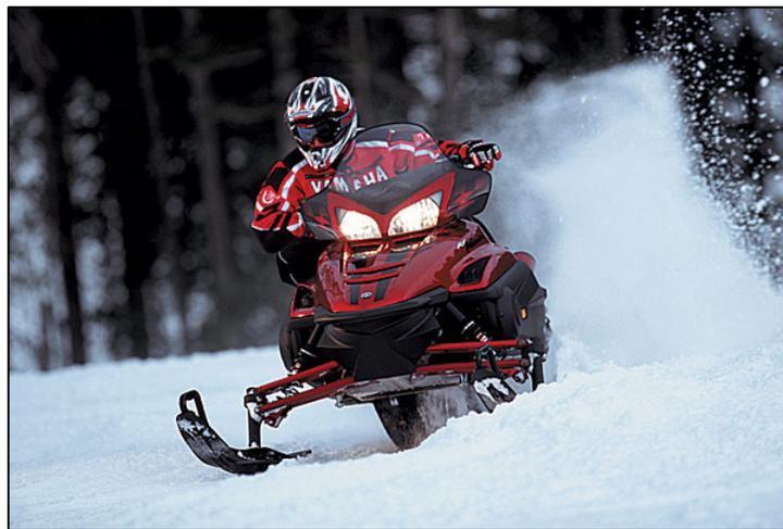
**Photo 1.11** Les skis, la chenille et la suspension d'une motoneige sont autant d'éléments contribuant à la formation de bosses
