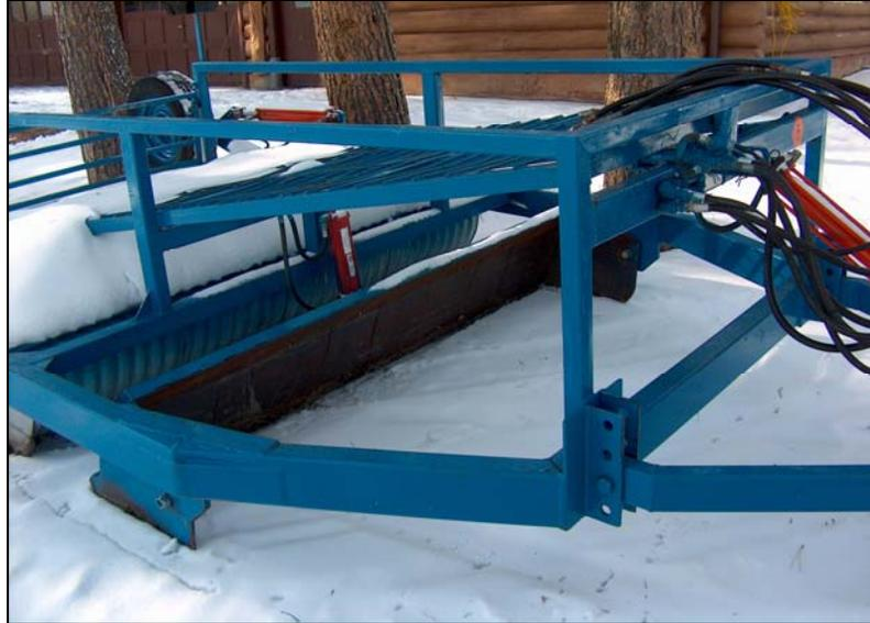
**Photo 2.19** Lame de raclage simple de type courant
