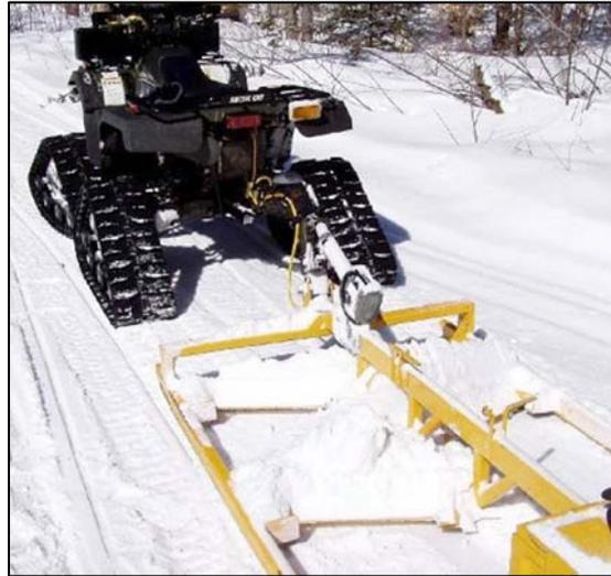
**Photo 2.32** Dameuse de type courant tractée par un VTT
