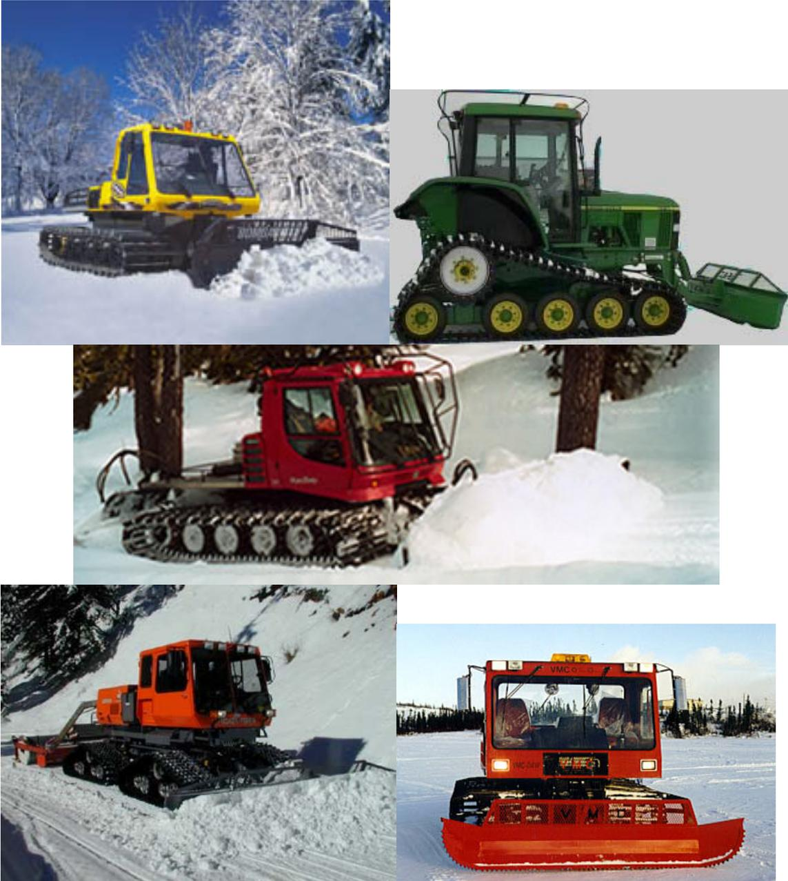
Photo 2.25 Tracteurs de damage de type courant
