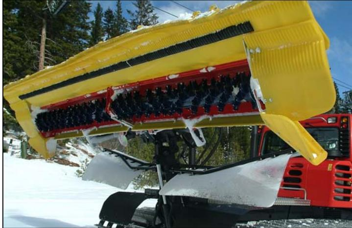
**Photo 2.21** Vue de dessous d'un mélangeur
