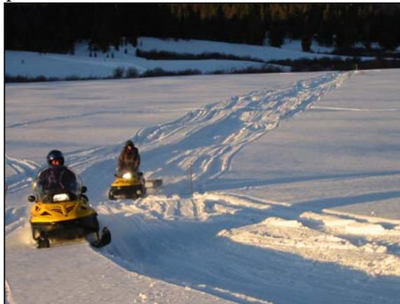
**Photo 1.1** La circulation des motoneiges rend les pistes cahoteuses, ce qui nécessite un damage
